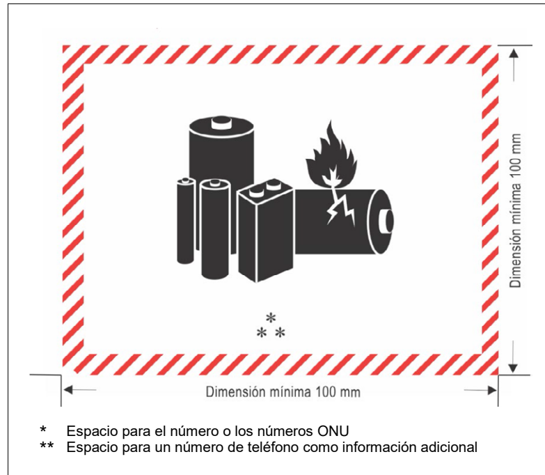
Figura 5-3. Marca de baterías de litio
