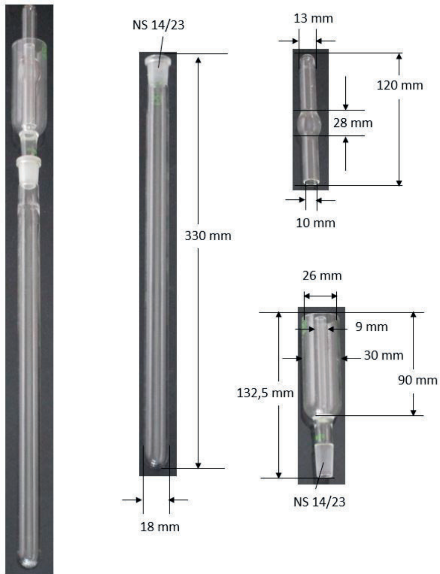
Figura A10.1: Cámara de condensación del ejemplo 1 de la prueba de Bergmann-Junk
