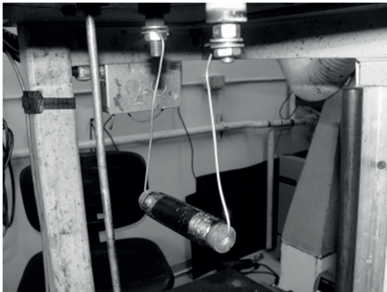
Figura 18.8.2: Celda de prueba montada horizontalmente bajo la cubierta del recipiente a presión (con los conductores de cobre conectados a los electrodos fijos del recipiente)
