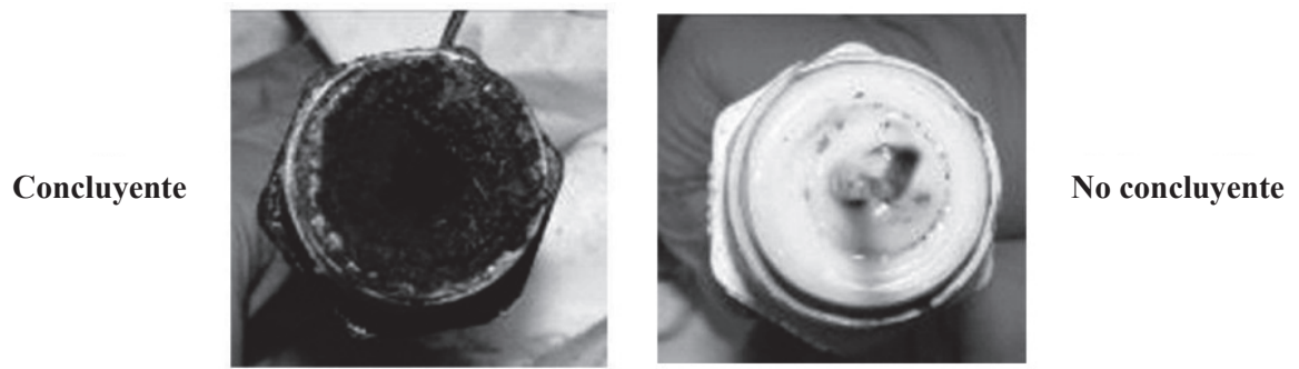
Figura 18.8.3: Aspecto típico de la celda de prueba tras una prueba concluyente (izquierda) y no concluyente (derecha)
